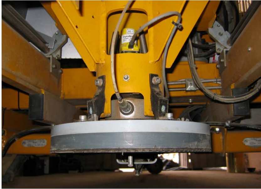
Hình 6. Tấm ép truyền tải trọng tác dụng xuống mặt đường
